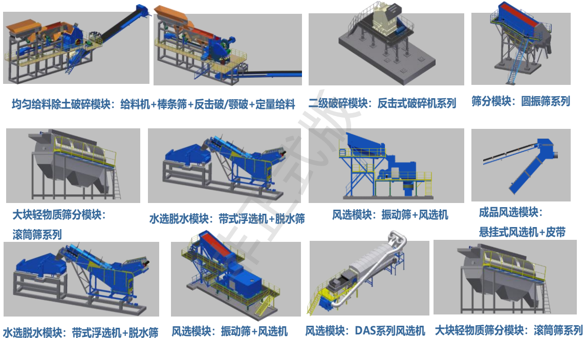
图5 基于多源固废的处理工艺和用途对整体装备的模块化设计
